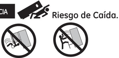
Los modelos con estilo incorporado (modelo PYE, CYE, GYE, DYE, PWE, CWE, y ZWE) son inestables, especialmente con las puertas abiertas. Estos modelos deben ser asegurados con el soporte anti-volcaduras, a fin de evitar caídas hacia adelante, que podrían resultar en la muerte o lesiones graves. Lea y siga las instrucciones de instalación en su totalidad, a fin de instalar el soporte de piso anti-volcaduras embalado con su refrigerador.
