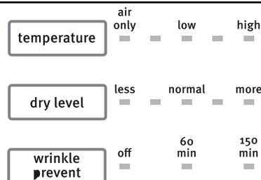
Pour ajouter des options supplémentaires, appuyer sur le bouton correspondant à l'option souhaitée. S'il n'est pas possible de retirer rapidement la charge, sélectionner l'option Wrinkle Prevent (antifroissement) avant d'appuyer sur START (mise en marche).
