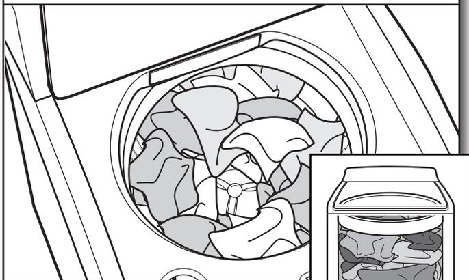
Pour un meilleur rendement, il est recommandé de déposer les vêtements en vrac et de façon uniforme le long du plateau de lavage. Essayer de mélanger des articles de différentes tailles pour réduire l’emmêlement.
