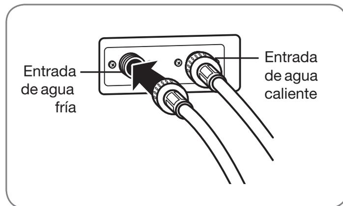
4. Conecte la tubería de agua caliente (roja) a la entrada de agua caliente ubicada en la parte trasera de la lavadora. Conecte la tubería de agua fría (azul) a la entrada de agua fría situada en la parte posterior de la lavadora. Ajuste las uniones con firmeza.
