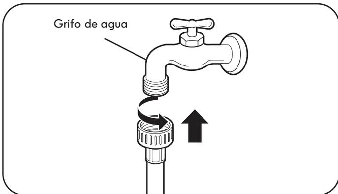
**NOTA:** Cuando instale las mangueras a las válvulas de entrada de agua, tenga cuidado de no enroscar mal los accesorios de la manguera. NO apriete en exceso las mangueras; esto podría causar daños a los componentes internos, la válvula o la junta de la manguera. El apriete excesivo puede ocasionar daños materiales debido a las fugas.
