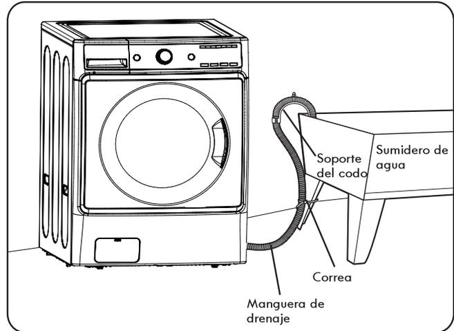
El soporte de codo debe estar instalado cerca del extremo de la manguera de drenaje. Cuelgue el extremo de la manguera de drenaje por el lado del sumidero de agua. Use una correa para asegurar la manguera de drenaje en su lugar.
