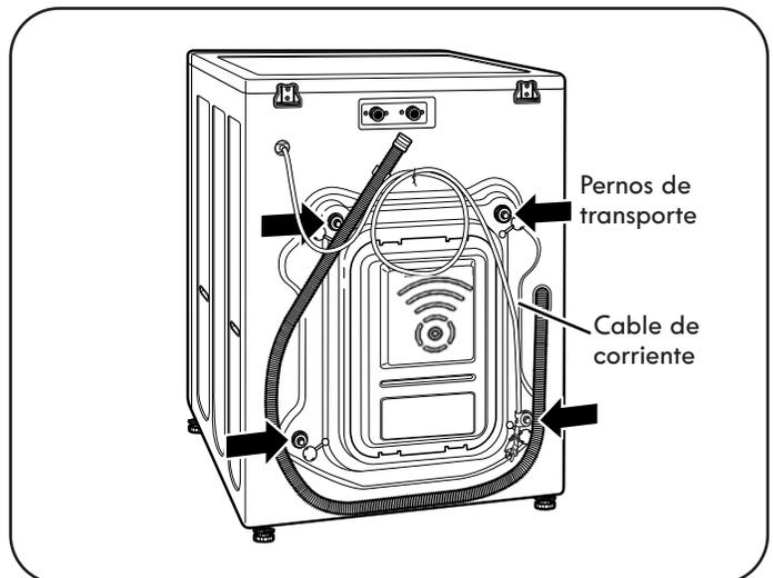
1. Comience con los dos pernos de transporte inferiores y utilice la llave de pernos (incluida) para aflojar completamente los cuatro pernos de transporte girándolos hacia la izquierda.
