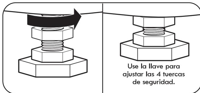
3. Una vez que la lavadora esté nivelada de lado a lado y de adelante hacia atrás, utilice la llave para apretar las cuatro tuercas de fijación y fíjelas a fin de evitar que las patas se desajusten durante el funcionamiento. Asegúrese de que las cuatro patas están en contacto directo con el suelo.
