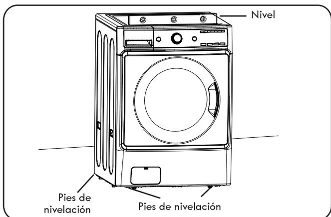
1. Coloque la lavadora en su ubicación final, teniendo especial cuidado de no presionar, tirar excesivamente o aplastar las tuberías de agua y drenaje. Coloque un nivel sobre la parte superior de la lavadora.
