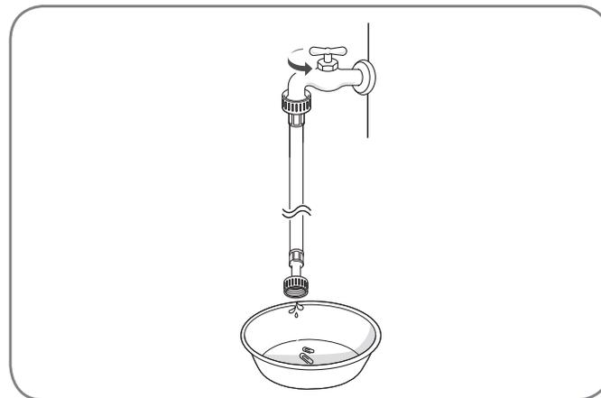
3. Siempre deje fluir uno o dos litros de agua a través de cada manguera de entrada para ayudar a evitar futuros problemas con pantallas de filtro obstruidas al vaciar la suciedad, depósitos de minerales y otros residuos de las tuberías de agua. De paso, al hacerlo comprobará cuál es la manguera de agua caliente y cuál la de agua fría.
