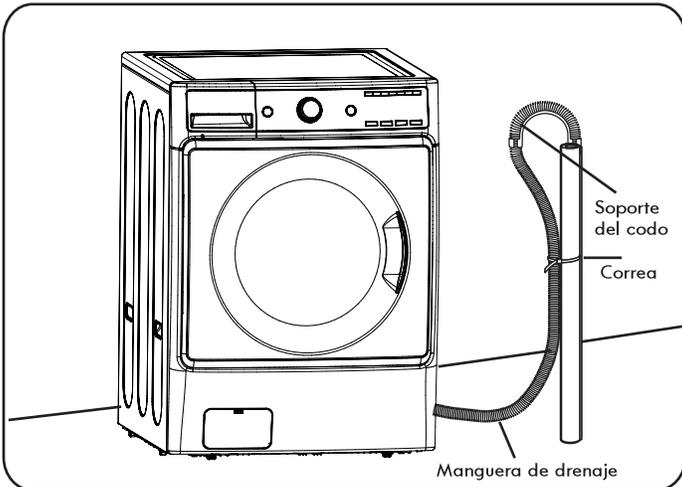
Ingrese el extremo de la manguera de drenaje en el soporte del codo. No extienda la manguera de drenaje más de 10,1 cm (4 pulgadas) más allá del extremo del soporte del codo. Use una correa para asegurar la manguera de drenaje en su lugar.
