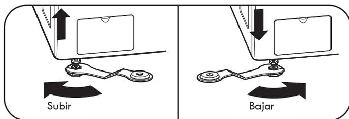
2. Afloje las tuercas de fijación de las cuatro patas de nivelación con la llave hasta que ajuste las patas (aspecto llave puede variar). Utilice la llave para girar las patas hacia la derecha para elevar la lavadora, y en sentido contrario para bajar la lavadora. Con un nivel, ajuste las patas hasta que la lavadora quede nivelada de lado a lado y de adelante hacia atrás. Asegúrese de que las cuatro patas están en contacto directo con el suelo.
