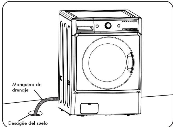
Inserte el extremo de la manguera de drenaje en el desagüe del suelo. Si es posible, fije la manguera para evitar que se mueva o se salga del desagüe.
