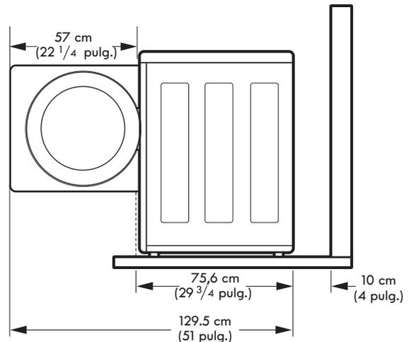
Para asegurar que se haya dotado de suficiente espacio para las tuberías de agua y flujo de aire, deje espacios mínimos de por lo menos 2,5 cm (1 pulgada) en los lados y de 10 cm (4 pulgadas) detrás de la unidad. No olvide tener en cuenta las molduras de paredes, puertas o piso, que podrían aumentar la distancia de separación necesaria.
