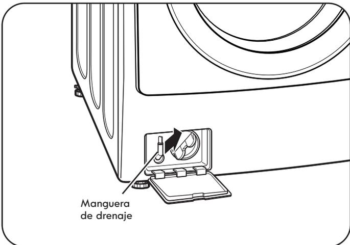
**2** Desconecte la manguera de drenaje y tire de ella. Coloque el extremo de la bomba de drenaje en un recipiente llano o en el desagüe del suelo. Asegúrese de no tirar demasiado la manguera, o es posible que no drene de manera adecuada.
