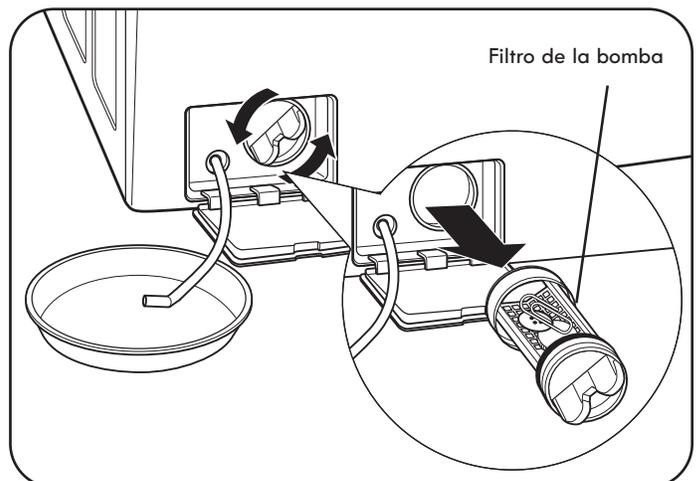
**4** Gire el filtro de la bomba hacia la izquierda para retirarlo. Elimine cualquier pelusa y objeto extraño del filtro de la bomba. Vuelva a colocar el filtro de la bomba en la apertura y gire a la derecha para asegurarlo. Asegúrese de cerrar el panel de acceso al filtro de la bomba de drenaje.
