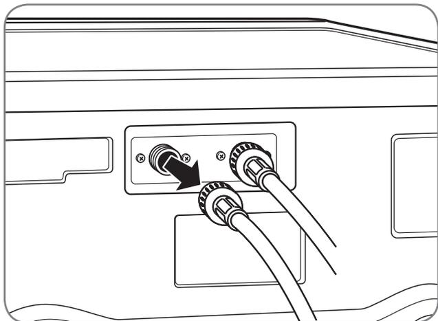
**1** Cierre las dos llaves de agua completamente. Desenrosque las tuberías de agua caliente y fría de la parte posterior de la lavadora.
