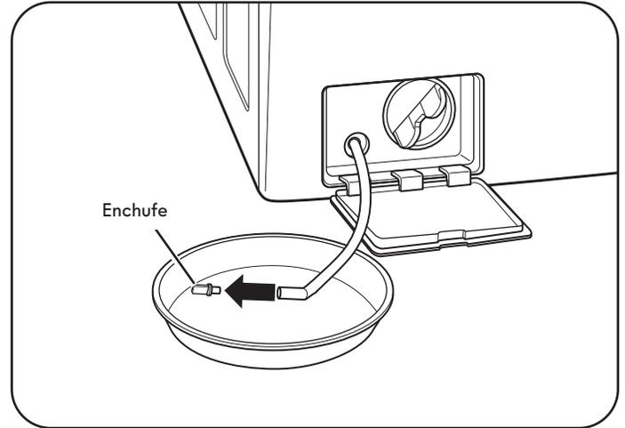
**3** Retire el conector de la manguera de drenaje y permita que el agua drene por completo.
